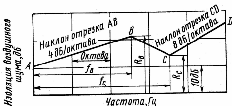
Рис. 2.53. Частотная характеристика изоляции воздушного шума однослойным плоским ограждением из металла или стекла
