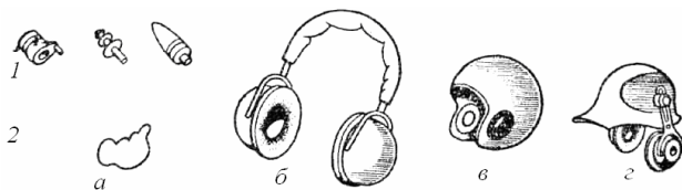
Рис. 2.67. Характерные типы средств индивидуальной защиты от шума: a – вкладыши: 1 – многократного пользования; 2 – однократного пользования (из волокнистого материала); б – наушники; в – шлем; г – каска с наушниками
